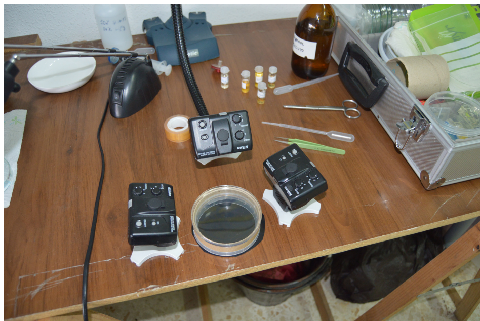
Figura 5. Proceso fotográfico. Los ejemplares se situaban en una placa Petri con fondo oscuro y eran iluminados por tres flashes independientes. Sobre la mesa, pinzas y chupones utilizados para la manipulación de los ejemplares.
